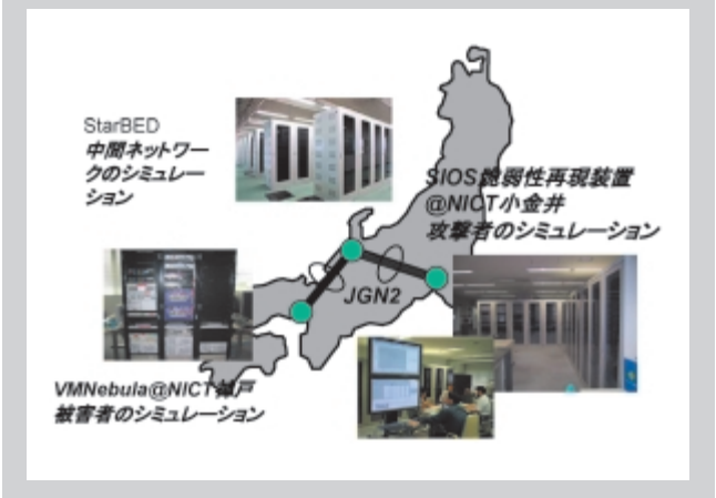
図 3 テストベッド間結合による検証環境
