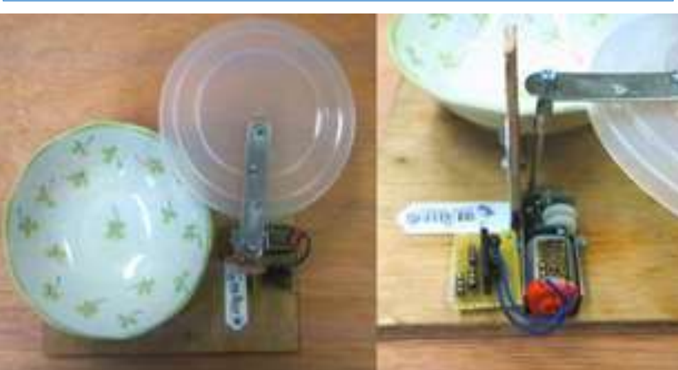
サーボモーターで蓋が閉まる皿
