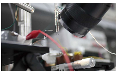
先端が鋭いSPM探針を電解研磨によって作成。
