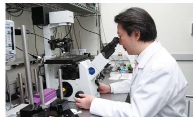
自作の全反射型近接場蛍光顕微鏡(TIRFM)でポリマー1分子の蛍光発光をイメージングしているところ。
