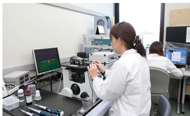
高速原子間力顕微鏡(高速AFM)によってポリマーの動きの観測を行っている。
