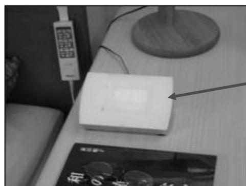
図4. 2. 5-11 音声認識リモコン
