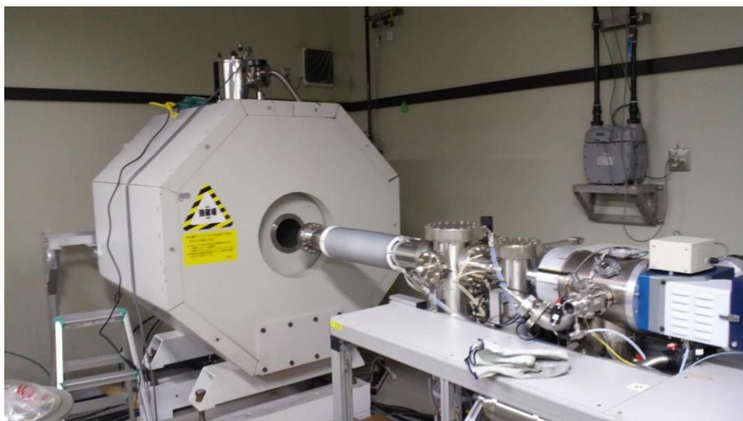
Fig. 1 廃棄作業を行った 7T FT-ICR MS (BioAPEX70e)
