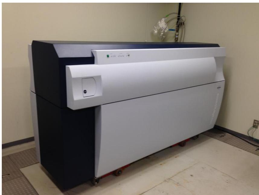
Fig. 6 本学に導入された MALDI-TOF/TOF (UltrafleXtream)
