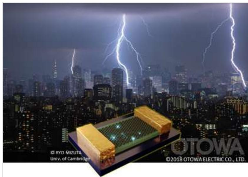
このグラフェンセンサをモジュール化して、屋外で雷雨時に動作試験を行ったところ、20km以上離れた地点での落雷を電界ピーク信号として検出することに成功しました。さらに、測定された電界の時間発展データを特異スペクトル変換法で解析することで、5 km圏内の落雷を32分前に予測できることも見出しています。これらの新技術を統合すれば、既存技術では困難だった多数のセンサ素子を広域に配置した落雷検出ネットワークの構築が容易となり、高精度な襲雷予測の実現に向けた大きな前進が期待できます。
