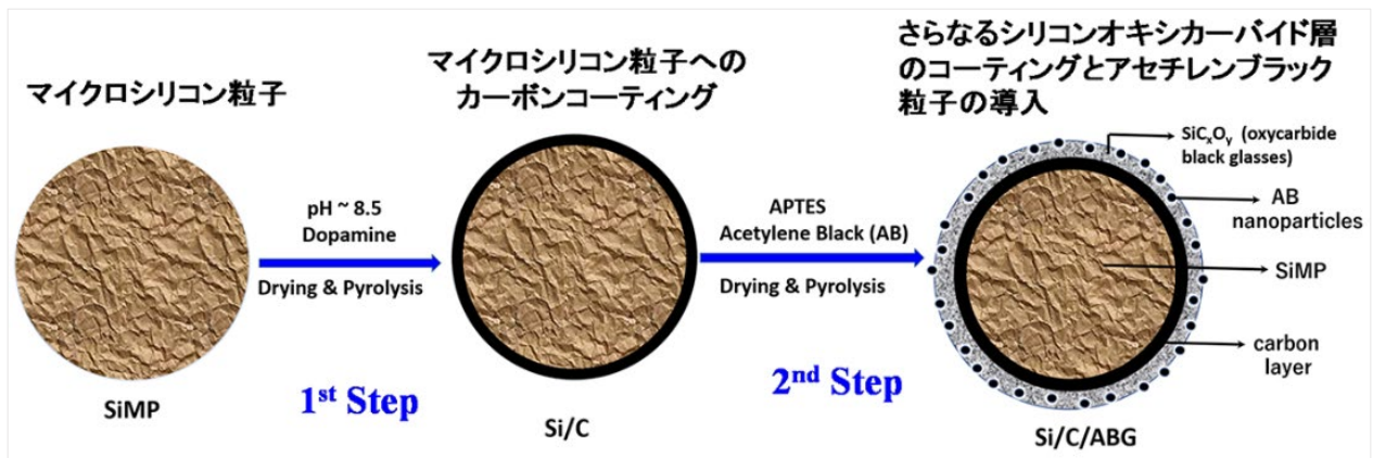
図. マイクロシリコンへのシリコンオキシカーバイド層導入の手順
