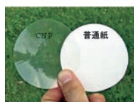
図3. (左)セルロースナノペーパー(CNP)と普通紙との比較(阪大 能木提供)。(右)CNPを基板とした薄膜トランジスタ(TFT)の模式図。
