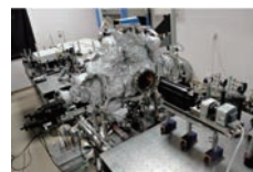
図2. 世界で唯一の超高真空光和周波顕微鏡
