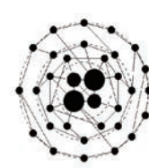
同程度の次数を持つノードが結合した玉型構造による頑健性の向上
