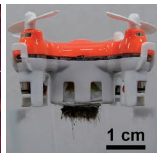
図2. 全自動人工花粉交配を目指したミツバチ型ロボット(プロトタイプ)。効率的に花粉を運ぶために粘着性ゲルを塗布した動物体毛を極小ドローンの下部に取り付けている。
