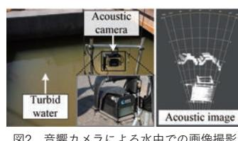
図2. 音響カメラによる水中での画像撮影
