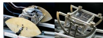
写真2. 摺動と揺動を利用した劣駆動移動ロボット
